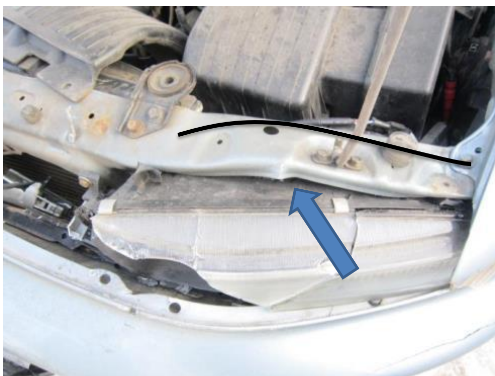
Поврежденная геометрия планки радиатора
