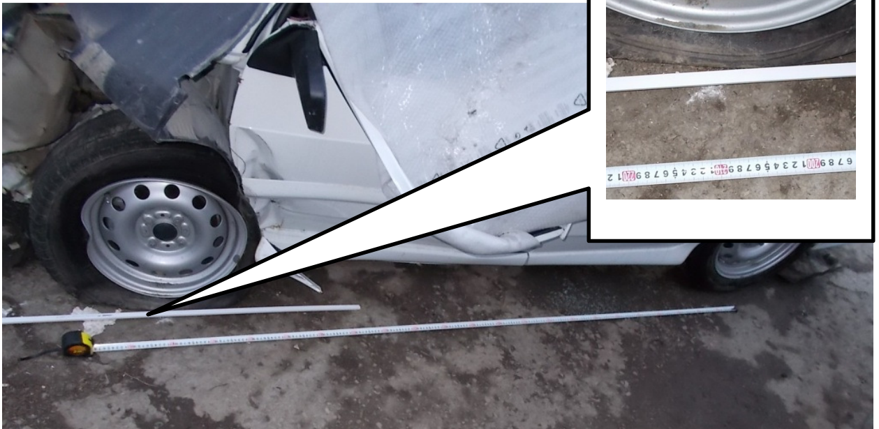
Фото 1.6. Расстояние между проекцией оси заднего левого колеса и проекцией оси переднего левого колеса 2100 мм. База данного ТС – 2460 мм, т.о. смещение переднего левого колеса на 360 мм спереди назад..
