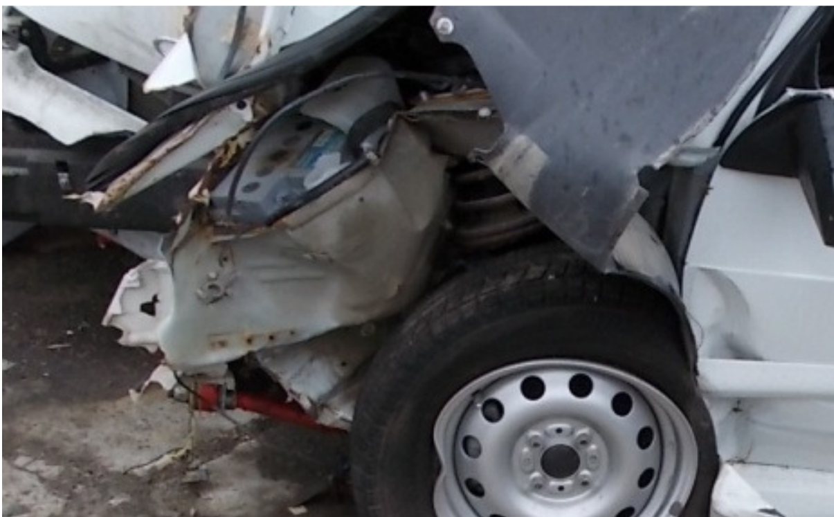
Фото 1.5. Повреждения лонжерона переднего левого, диска переднего левого колеса.
