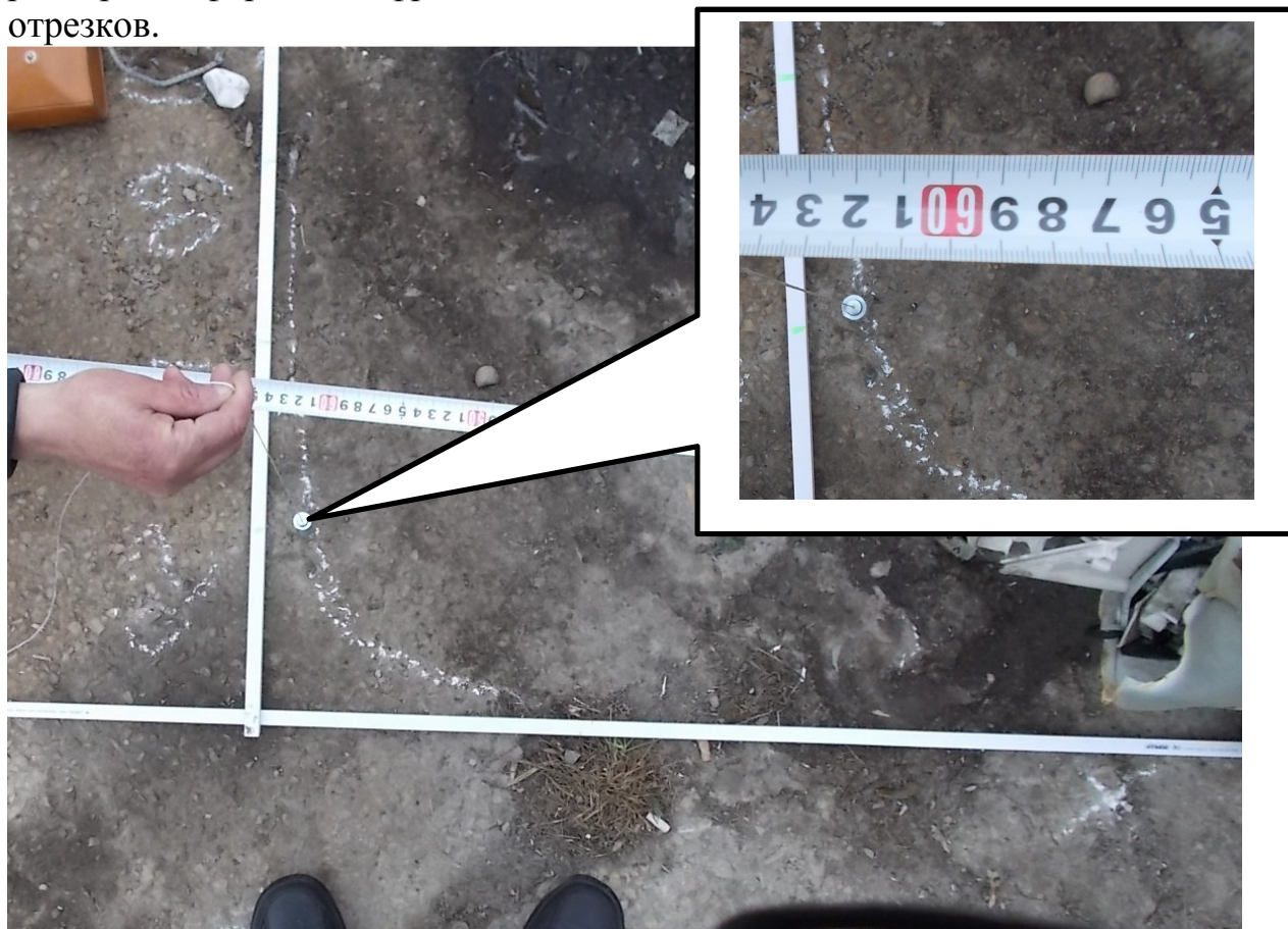
Фото 3.2. Измерение величины деформации от проекции переднего бампера до деформированной части ТС.
