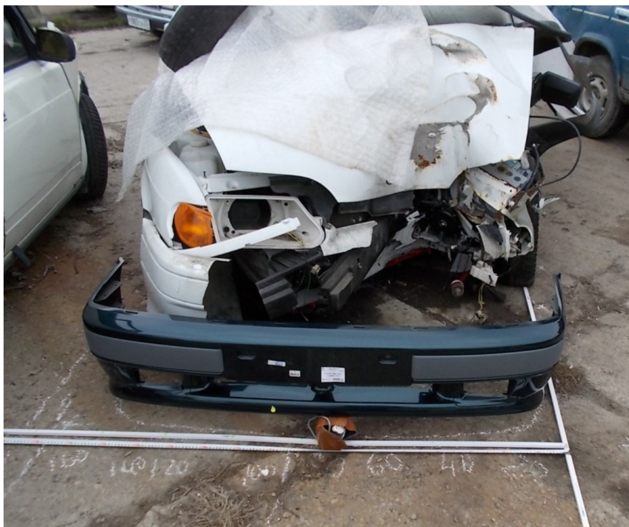
Фото 3.3. Указанные выше значения фронтальных деформаций нанесены на масштабный макет автомобиля ВАЗ 21144, результат показан на рис.2.
