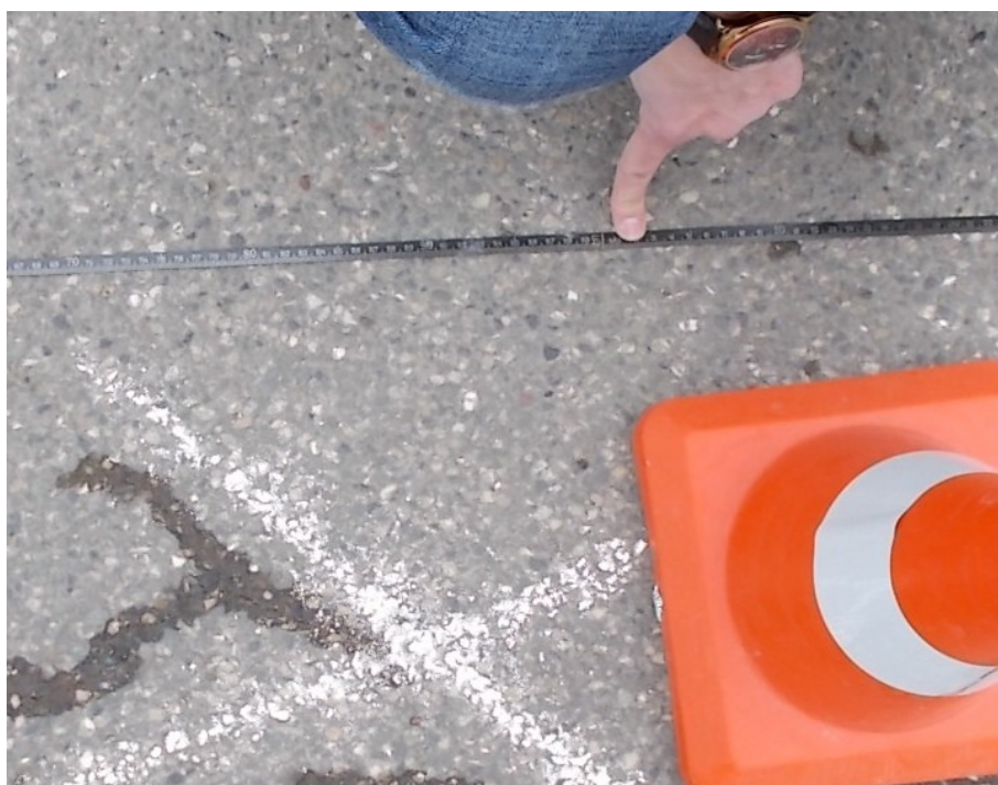
Фото 2.6. Фиксация расстояния между двумя отметками. Расстояние составляет 25м.
