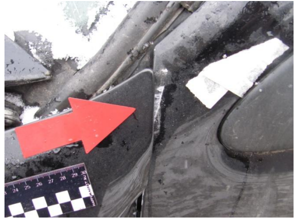
Фото №14 Нарушение зазора крыла лев.
