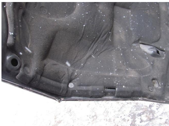
Фото №21 Шумоизоляция капота
